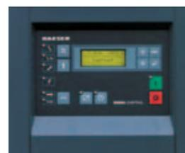
LED con funzioni intuitive (rosso, giallo e verde) segnalano lo stato operativo. Display retroilluminato con visualizzazione del testo in 30 lingue; tasti „soft-key“ con simboli e LED; verifica della percentuale di utilizzazione.
