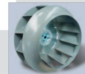
Potente e silenziosa, aspira attraverso i radiatori aria dall'ambiente. Per effetto della sua elevata prevalenza (curva caratteristica stabile), tollera senza difficoltà un eventuale intasamento del radiatore e possiede una riserva di spinta sufficiente per applicazione di canali per l'espulsione dell'aria.
