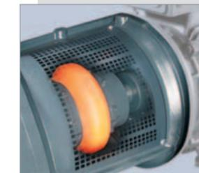
Molte persone, pensando ad una trasmissione diretta, la confondono in realtà con quella ad ingranaggi che, anche nel caso di rapporto 1:1, causa sempre un assorbimento di potenza. Si noti bene la differenza: nelle macchine ASD, tra motore e gruppo vite, è interposto solamente un giunto
