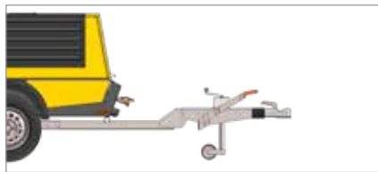
Timone rigido con freno a repulsione e di stazionamento
